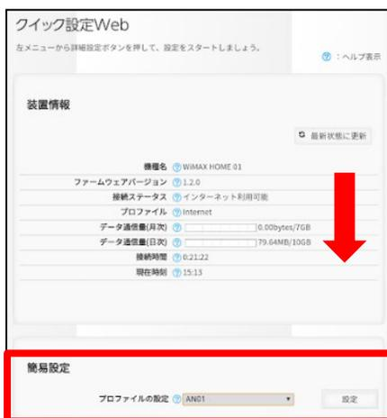
画面をスクロールして、画面下部にある「簡易設定」の「プロファイルの設定」の中から「AN01※」を選択し(①)、「設定」ボタンを押します(②)。
